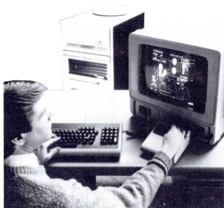
Gegevensbeheer op de VAX-11/730. Een 32-bits minicomputer, uitgerust met de grafische terminal VS11, voor technische en commerciële doeleinden.
